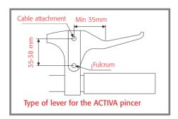
THE BRAKING SYSTEM HAS BEEN DESIGNED AND MUST BE UTILISED ONLY WITH HANDLE-BAR LEVERS THAT ARE OF THE V-BRAKE TYPE
